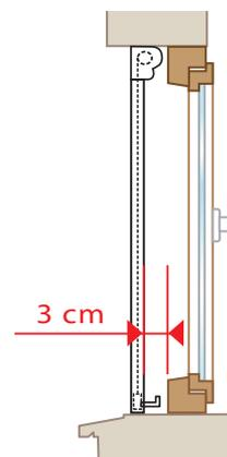
La partie arrondie du coffre et les poignées doivent être orientées vers l'intérieur de la pièce.
