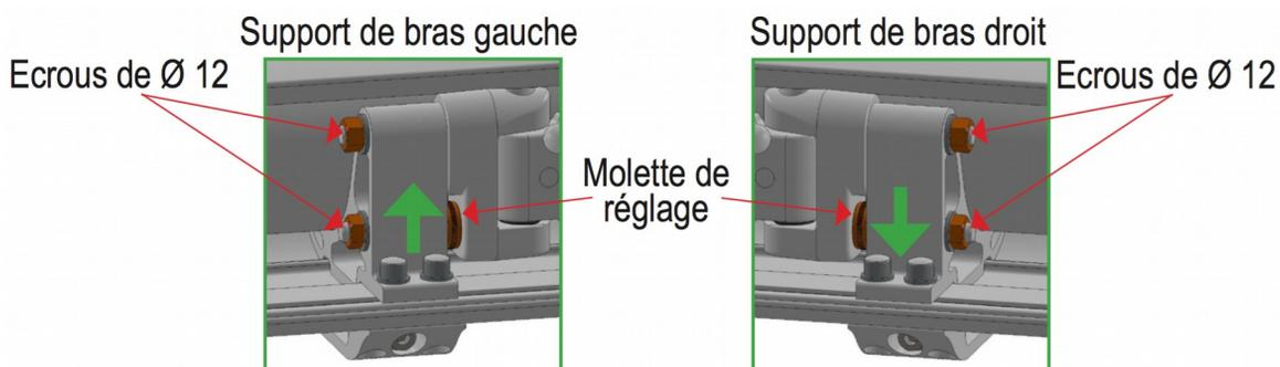
Les arrières bras doivent être parallèles au coffre, et les coudes doivent être à environ 1,5 cm du bas du coffre.
