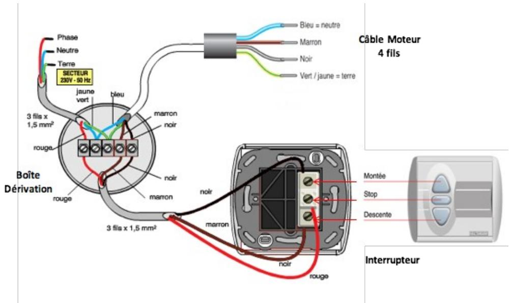
**CAS 3 : ARRIVEE COURANT DANS INTERRUPTEUR et MOTEUR A GAUCHE\***
