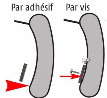
Il est préférable de positionner l'automatisme vent en bout de barre de charge (plus sensible en cas de vent) en veillant à ce qu'il ne gêne pas la fermeture du store.
