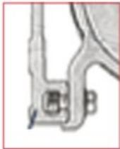
Accrocher le coffre sur les platines et le fixer avec les vis de fixation de platines.
