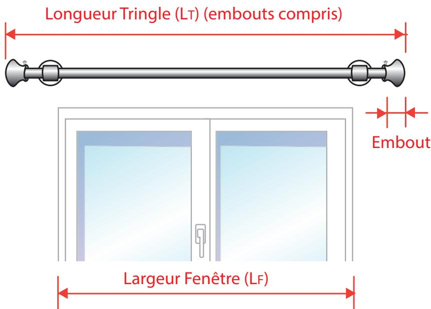
⚠ A partir de 200 cm (2 m) de longueur, les tringles décoratives sont livrées en 2 parties avec système de raccord invisible et 3e support (central)
